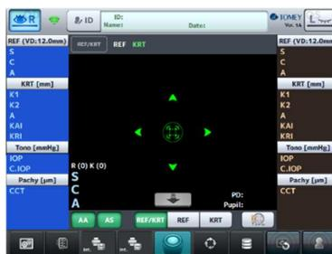
2) Realizar la alineación y tomar las mediciones con el joystick o el botón del joystick en la pantalla de medición.
